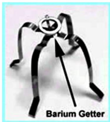
Бариевый газопоглотитель - расположен в нижней части внешней трубы.
