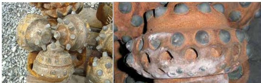
Рис.1. Фрагменты износа зубков, их поломки и вырва из отверстий корпуса шарошки
