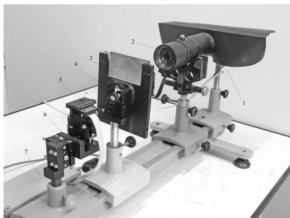
**Рис. 12.** Основные элементы установки для проверки ПЗС- линейки ДОЭ и юстировочного устройства:
