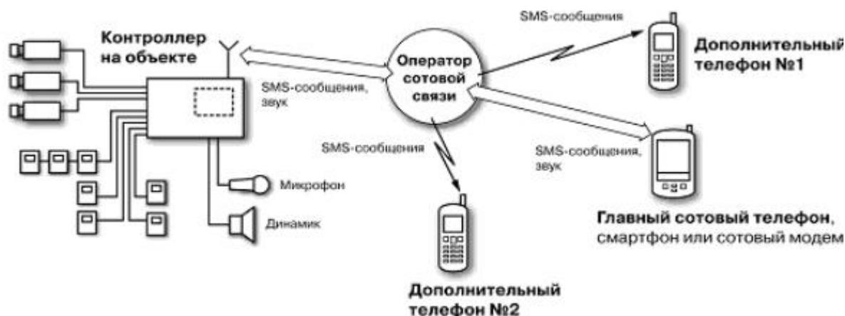
**Рис. 1.** Схема передачи информации в GSM охранной системе при использовании функции SMS.
